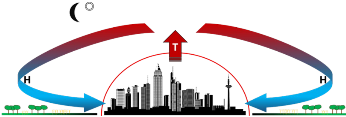
Abbildung 50: Darstellung eines Flurwindsystems am Beispiel des Stadt-Umland-Windsystems. Während einer strahlungsarmen Nacht steigen die wärmeren "Stadtluft"-Massen auf (geringere Dichte) um nach Abkühlung (höhere Dichte) wieder abzusinken. Zusammen mit den nach Sonnenuntergang entstehenden Kaltluftmassen des ruderalen Raums etabliert sich so ein sensibles Flurwindsystem (Sogwirkung, Luftdruckgegensatz).
