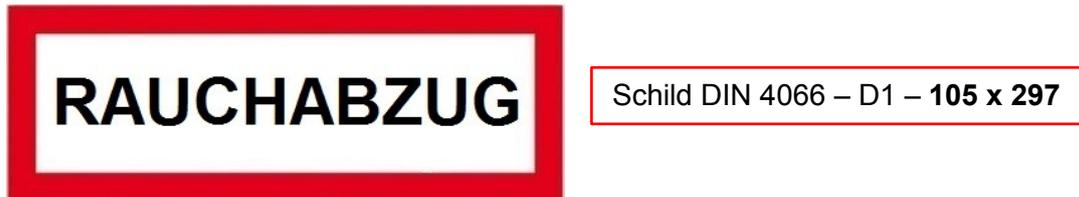
Abb. 3 Kennzeichnung von Rauchableitungsöffnungen (bspw. Tore), **gültig: wenn keine Rauchabzüge im Dach vorhanden sind!**
