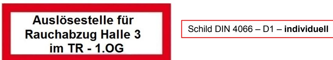
Abb. 5 Kennzeichnung von Auslösestellen für NRA in Sonderfällen
