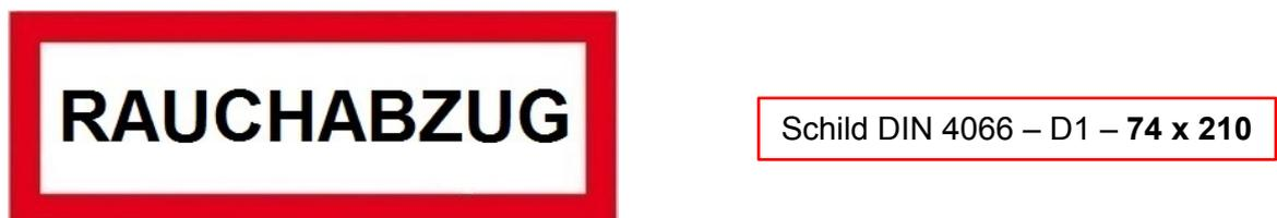
Abb. 2 Kennzeichnung von Bedienungsvorrichtungen zur Öffnung von Rauchableitungsöffnungen
