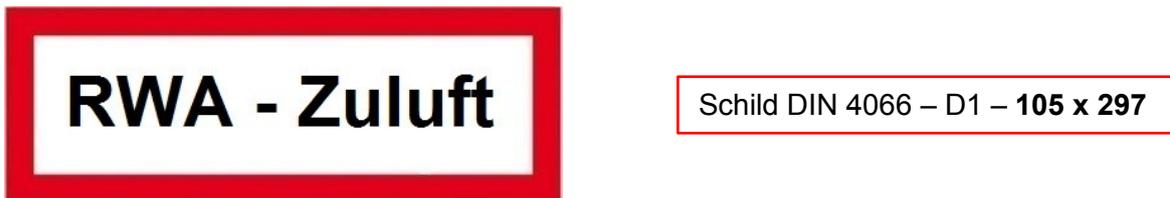
Abb. 1 Kennzeichnung von Zuluftflächen (bspw. Tore)
