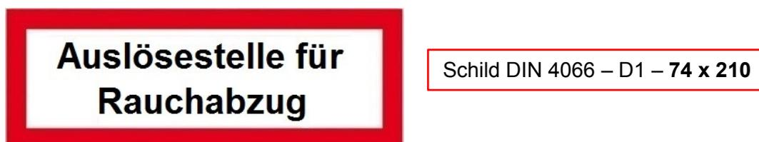
Abb. 4 Kennzeichnung von Auslösestellen für NRA
