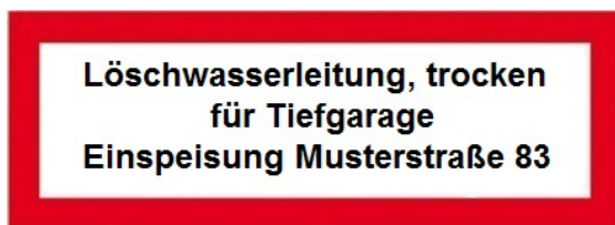
Abb. 3: Beispiel für den Hinweis auf eine Löschwasserleitung im Bereich der Rampe
