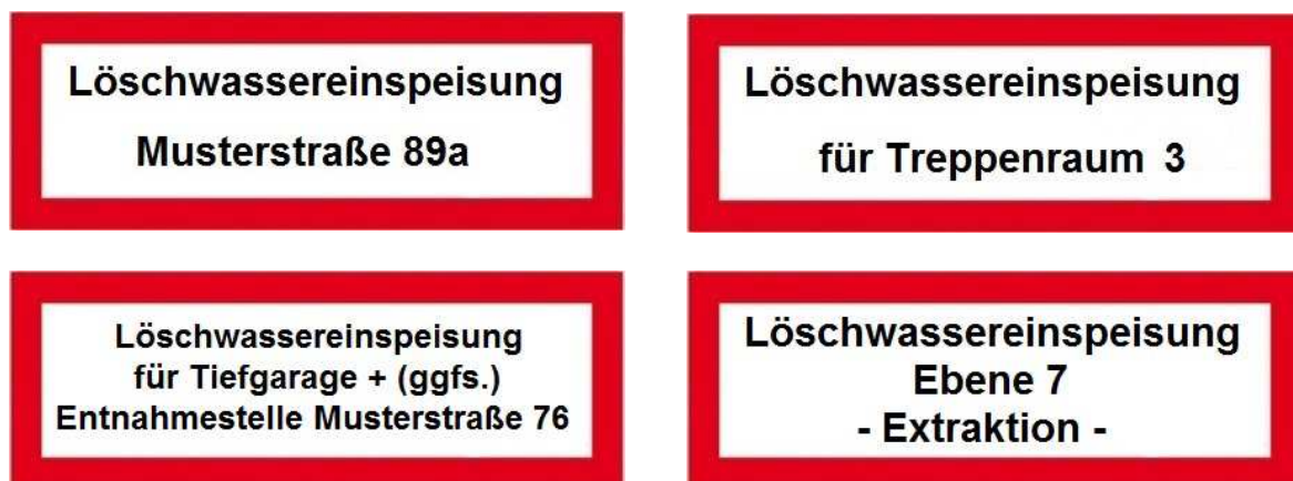
Abb. 1: Beispiele für die Kennzeichnung von Einspeisestellen
